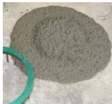
J 环提起后混凝土的形态
