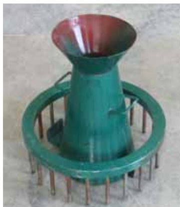
坍落度筒正立/倒立两种方法
