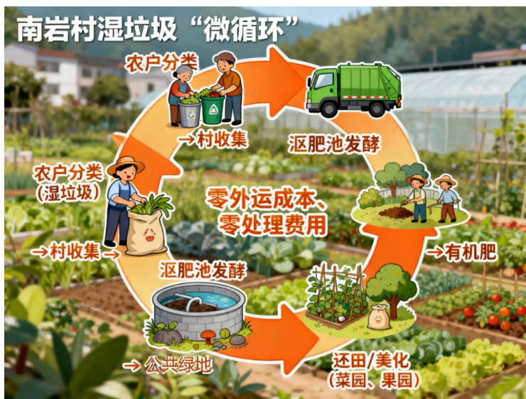
图 4：南岩村湿垃圾“微循环”利用示意图
